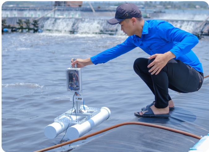
Hệ thống đo nồng độ pH trong nuôi tôm pH Meter in Shrimp Farming
